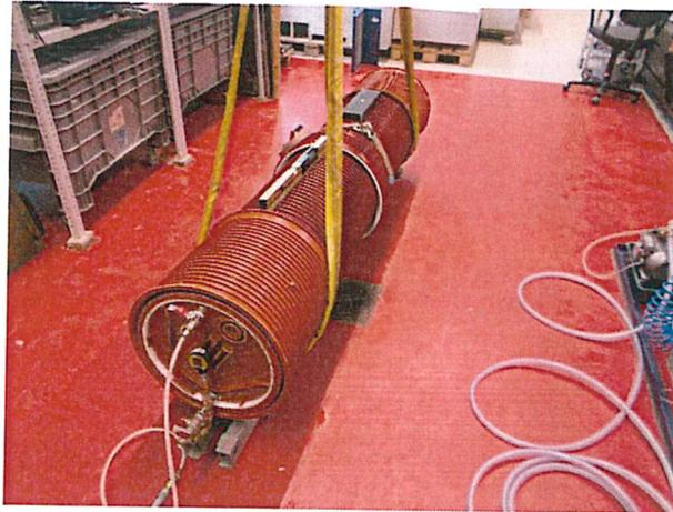
Gasdichtheit bei innerem Unterdruck nach Abwinkelung
