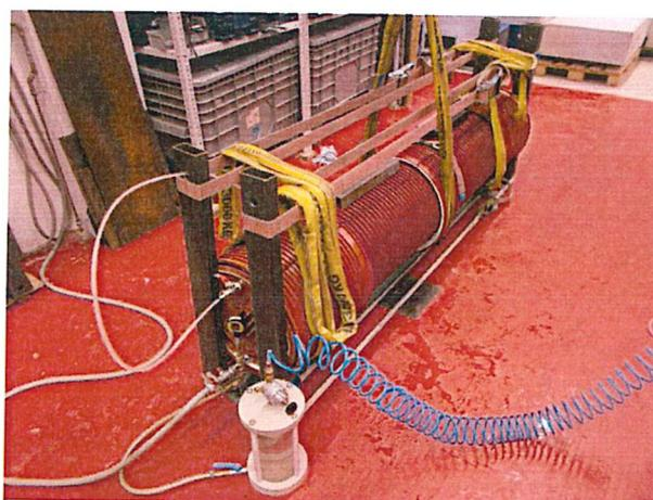
Wasserdichtheit bei innerem Überdruck nach Abwinkelung
