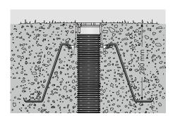
Die Walu-Endkappe dient als universelles, oberflächengleiches Abdeckelement. Über den ausschwenkbaren, verschlusssicheren Deckel ist eine problemlose Belüftung, Bewässerung und Zufuhr von Nährstoffen möglich.
