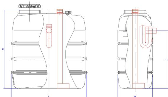
Kellerbasistank mit beruhigtem Zulauf und Überlaufsiphon
